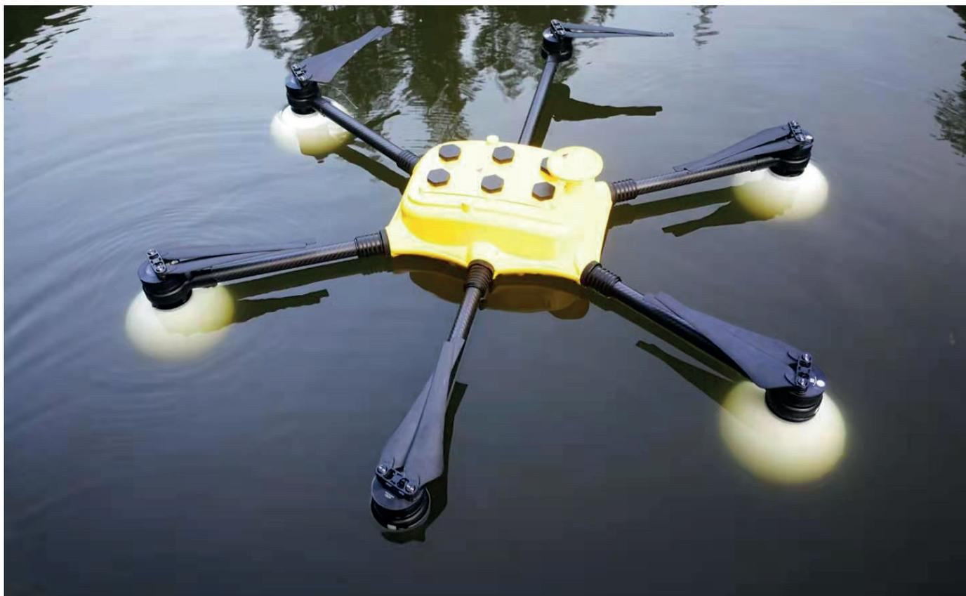
KS CONDOR L V2 – увеличенная версия БПЛА KS CONDOR L с 6 электродвигателями и большей грузоподъемностью до 5 килограмм.
